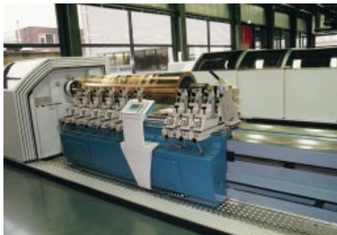
Der K406 mit geschlossener, geräuschkämmender Haube (Hintergrund) und mit geöffneter Haube (Vordergrund).
